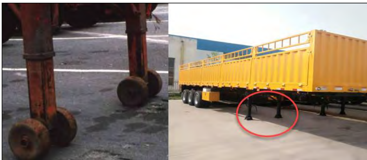
شکل ۳۳ نمونه‌هایی از چرخ‌های زیرسری (سمت چپ) و صفحات پاشنه‌ای (سمت راست)
